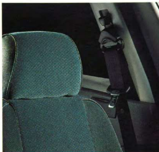
Beide versies zijn voorzien van in hoogte verstelbare veiligheidsgordels met spanners
