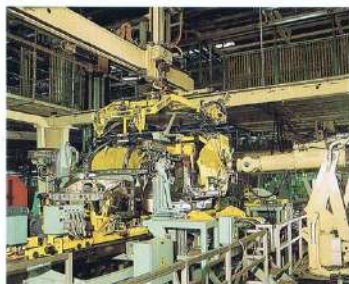
ロボットの導入によって、 精密なサイズ・チェックが行われます。 写真は車体のクック溶接の 様子です。
