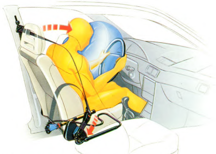
De airbag en de gordelspanners geven aanvullende bescherming bij frontale botsingen.
