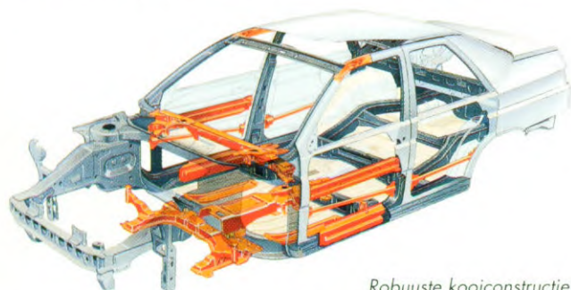
Robuuste kooiconstructie en verstevigingsprofielen in de portieren om de inzittenden rondom tegen aanrijdingsletsel te beschermen.
