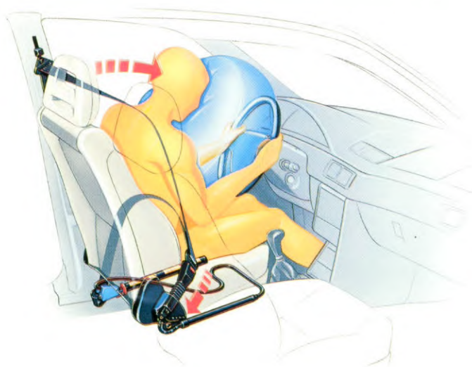
De airbag en de gordelspanners geven aanvullende bescherming bij frontale botsingen.
