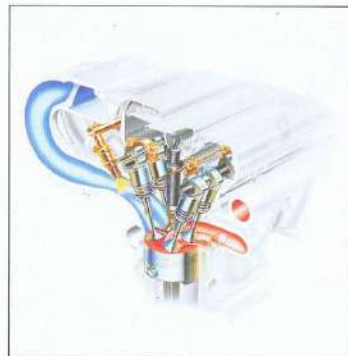
4バルブ・シリンダー、 ツイン・オーバーヘッド・カム・タイミング・システム。
