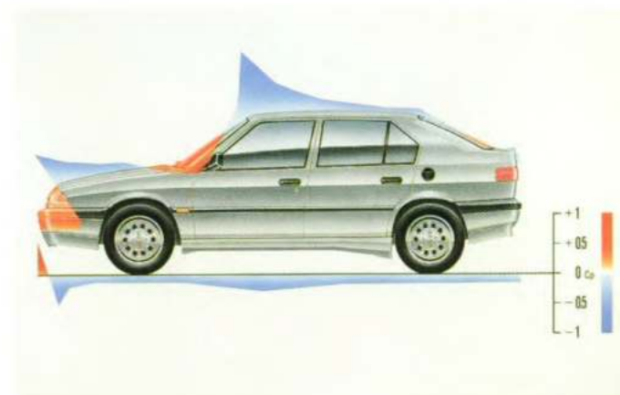
Het schema van de luchtdrukverdeling toont de zeer gunstige neerwaartse druk
