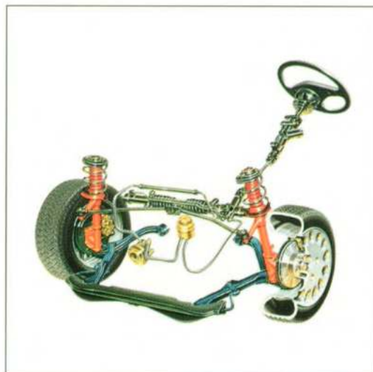
Voorwielophanging en hydraulisch bekrachtigde stuurinrichting
