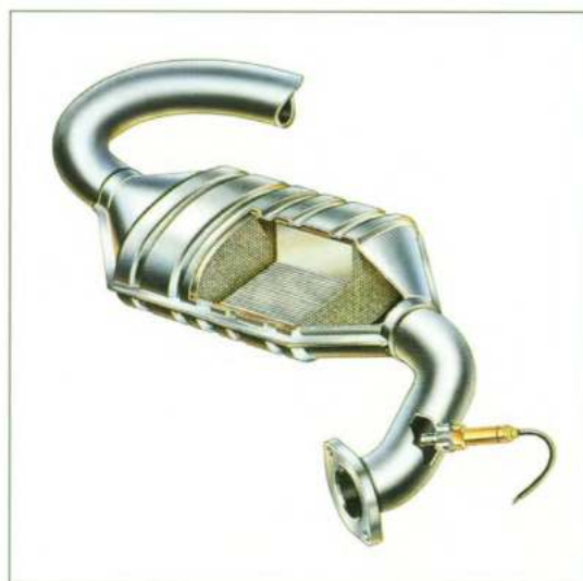
Driewegkatalysator met lambda-sonde
