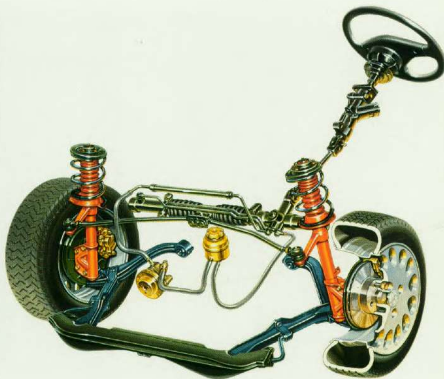
Voorwielophanging met hydraulisch bekrachtigde stuurinrichting
