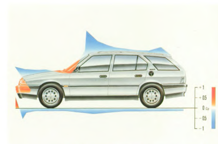
Uit de luchtdrukverdeling op de carrosserie blijkt duidelijk de gunstige aërodynamische vorm
