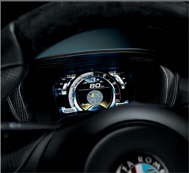
Combiné de bord Full Digital avec technologie TFT Casquette du combiné de bord en fibre de carbone
