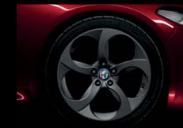
Leichtmetallfelgen 8J x 18" POTENZA mit Bereifung: vorne 225/45 R18, hinten 255/40 R18
