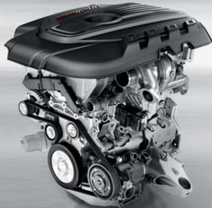
Jedes Detail der Giulia ist auf Spitzenleistung und Effizienz ausgerichtet. Die komplett aus Aluminium gefertigten turbogeladenen Motoren bieten eine Balance zwischen Leistung und Umweltverträglichkeit. Zur Wahl stehen ein 2,2-Liter-Dieselmotor, erhältlich mit 100 kW (136 PS), 110 kW (150 PS) oder 132 kW (180 PS). Alle Dieselversionen sind mit 6-Gang-Schaltgetriebe oder ab 110 kW (150 PS) mit 8-Gang-Automatikgetriebe verfügbar. So finden hier Emotion und Verantwortung zusammen.
