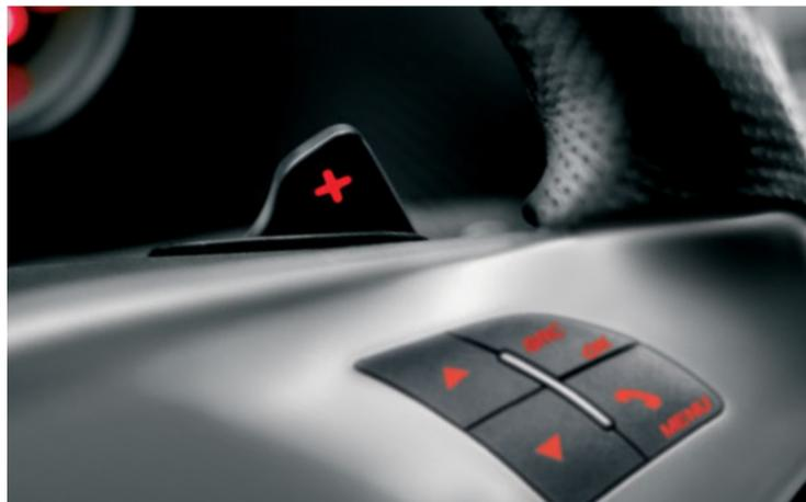
**CAMBIO ALFA TCT.** Un sistema di trasmissione con doppia frizione a secco, composto da due cambi in parallelo che consentono l'innesto della marcia successiva mentre quella precedente è ancora inserita. Può funzionare in modalità completamente automatica oppure sequenziale, attraverso il comando TIP, in questo modo le cambiate vengono gestite manualmente con le posizioni up e down della leva del cambio o attraverso i comandi al volante.
