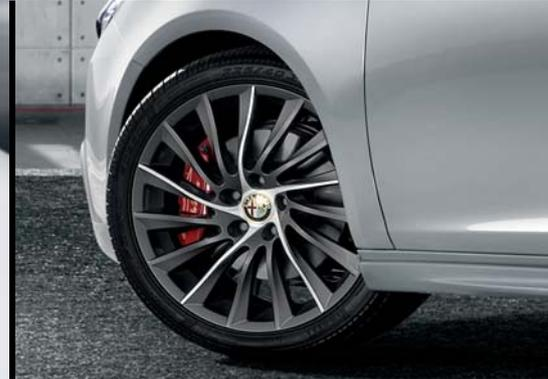
Turbinenrad mattiert in 7,5J x 18", in Mercury-Grey-Lackierung mit Bereifung 225/40
