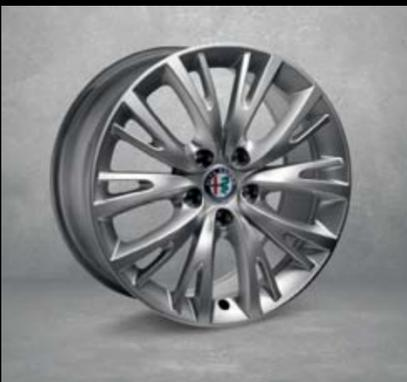
74B Llantas de aleación de 17" de radios con neumáticos 225/45
